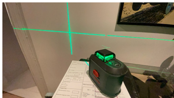
Skjevheter ble målt med elektronisk laservater på tilfeldig valgte steder i boligen.
