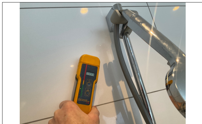
Kontroll med fuktmåler
