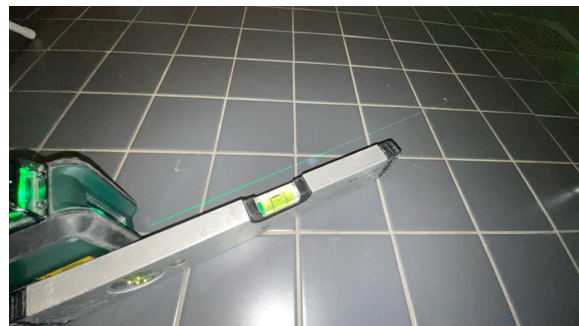
Fallforhold målt i retning sluk.
