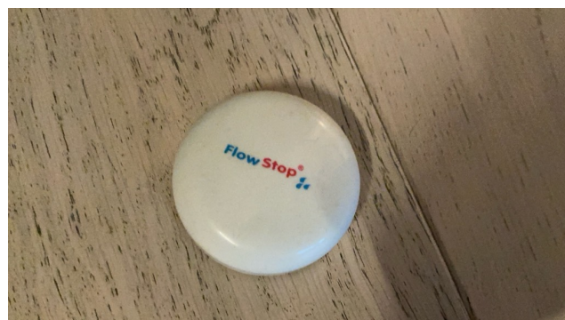
Flowstop lekkasjeføler under kjøkkenbenk
