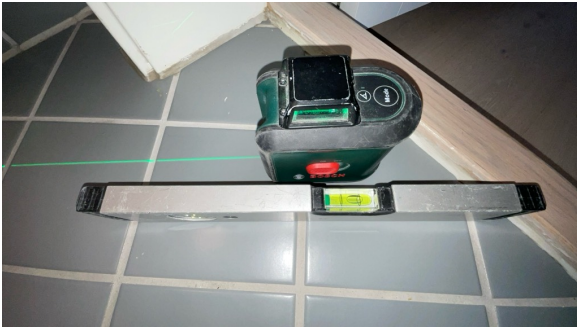
Fallforhold målt i retning sluk.
