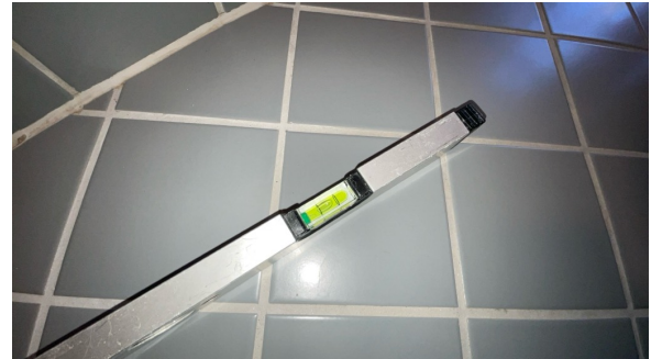
Fallforhold målt i retning sluk.
