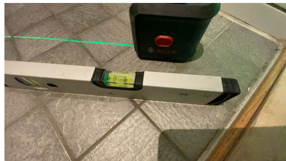
Fallforhold målt i retning sluk.
