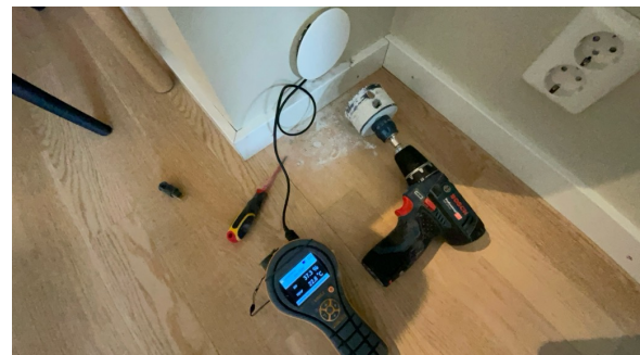
Hulltaking og fuktsøk med Protimeter piggelektrode ga ingen unormale utslag.
