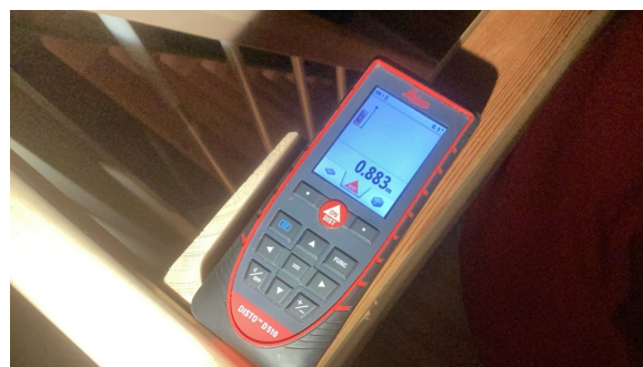
Høyde retur-rekkverk 88 cm.
