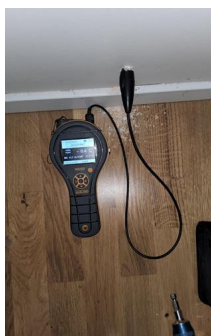
Utført kontroll i tilliggende konstruksjon - Fuktmåling
