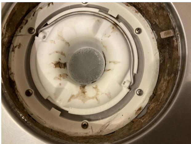
Klemring og synlig membran.
