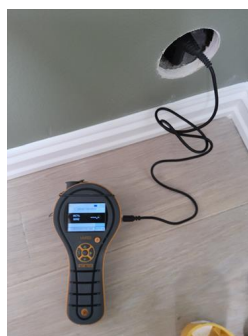
Utført kontroll i tiliggende konstruksjon - Piggelektroder
