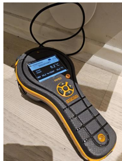
Utført kontroll i tiliggende konstruksjon - Fuktmåling bad
