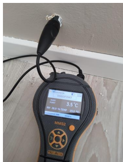
Utført kontroll i tilliggende konstruksjon - Fuktmåling
