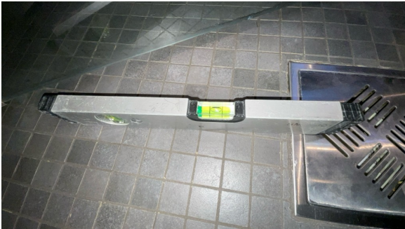
Fallforhold målt i retning sluk.
