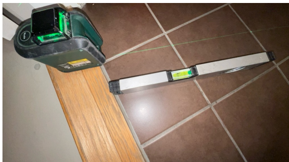
Fallforhold målt i retning sluk.
