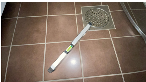
Fallforhold målt i retning sluk.
