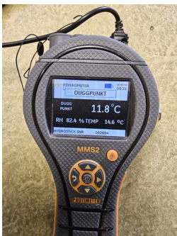
Stikktaking i treverk, fukt og fuktmålinger - Fuktmåling.
