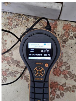
Utført kontroll i tilliggende konstruksjon - Fuktmåling.
