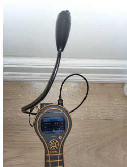
Utført kontroll i tilliggende konstruksjon - Fuktmåling
