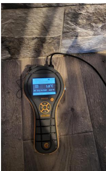
Kontroll i lukkede konstruksjoner - Fuktmåling
