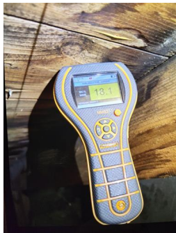
Synlige overflater (taktro, vegger, gulv, o.l) - Fuktmåling med pigg i treverk
