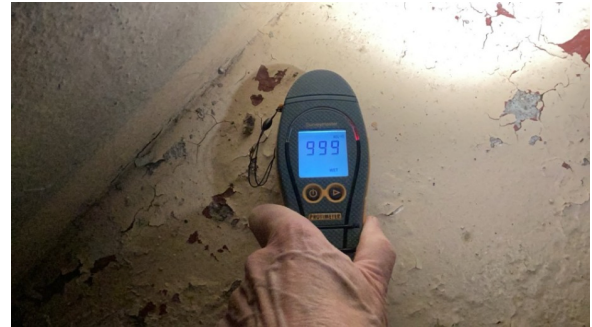
Ved fuktmåling registrerte jeg risikable verdier for skadelig fukt, det indikerer at konstruksjonen er utsatt for fuktpåkjenning.
