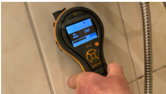
Fuktsøk med Protimeter MMS
