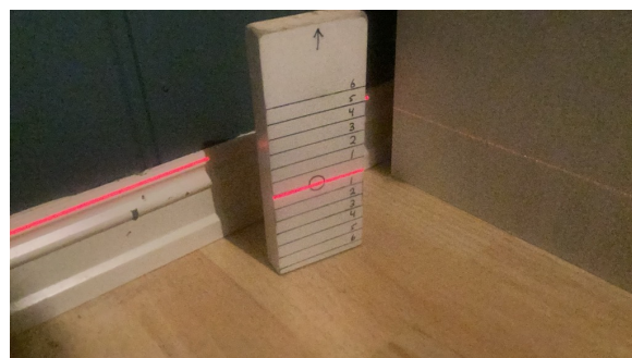
Soverom mot gårds plass, retningsavvik.
