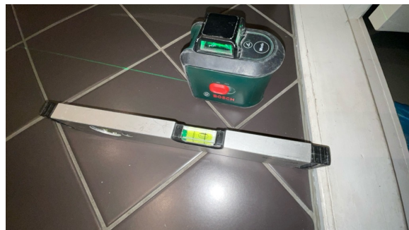
Fallforhold målt i retning sluk.
