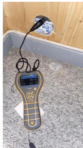
Konstruksjoner (tilfarergulv, himling og vegger). - [Hulltaking og fuktmåling i utlektet kjellervegg - Bod 5]
