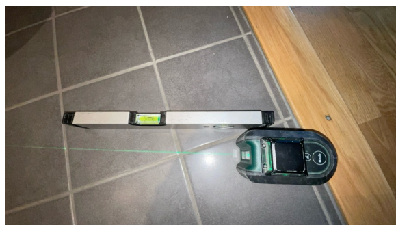
Fallforhold målt i retning sluk.
