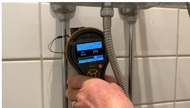
Fuktsøk med Protimeter MMS
