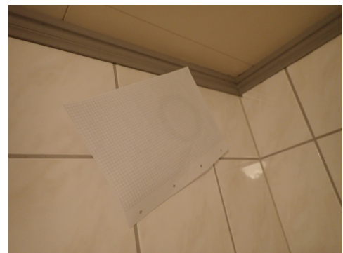
Avtrekk er testet med papirark
